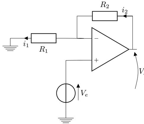
On a un montage amplificateur non inverseur idéal. Donc  $V_+ = V_- = V_e$ . Et comme  $i_1 = i_2$  on a  $\frac{V_s}{V_e} = 1 + \frac{R_2}{R_1} = G_v$  gain du montage. Si  $R_1 = R_2$  alors  $G_v = 2$
