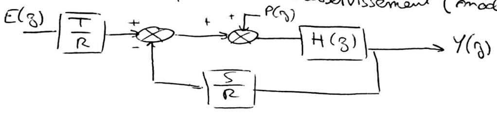
$\rightarrow$  Rappel:  $H(z) = \frac{b_1 z + b_0}{z^2 + a_1 z + a_0} = \frac{b_1 z + b_0}{(z-1)(z-D)}$  avec  $D = e^{-T_e/2}$
