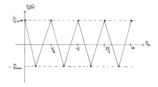
3. Nous en déterminons la période de ce flux qui est de  $\frac{\pi}{2}$  (la période de l'angle électrique est donc de  $\frac{2\pi}{p}$  avec p est le nombre de paire de pôle de la machine) et nous en déduisons la relation entre les angles électriques  $\theta_e$  et mécaniques  $\theta_m$ .
