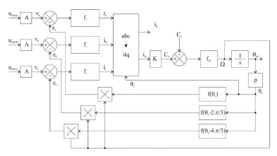
avec  $f_i = \frac{1}{R}$ ,  $f_{\Omega} = \frac{1}{jJ\omega}$  et  $f = sin(\bullet)$
