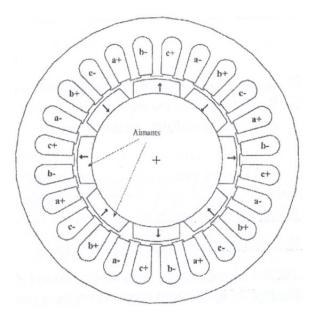
1. L'allures des lignes de champ dues uniquement aux aimants du rotor sont allistrées par le schéma suivant.
