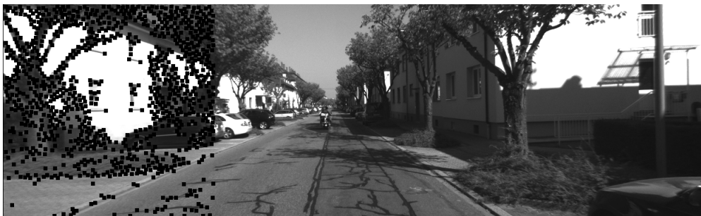
FIGURE 2 – Exemple de détection de coins sur une partie de l'image
