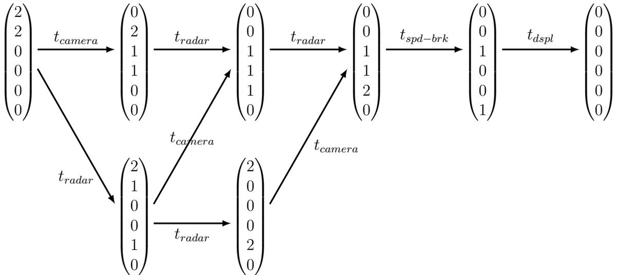
Comme on le voit, il faut 2 activations de  $t_{radar}$  sont nécessaires pour une activation de  $t_{camera}$ , d'où  $f_{radar} = 2.f_{camera} = 120Hz$ .
