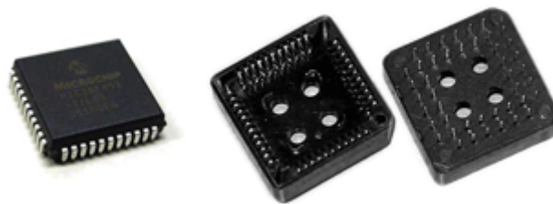
FIG. 41 – PIC18F452-I/L + support (format PLCC, 44 broches, dont 4 broches non connectés)
