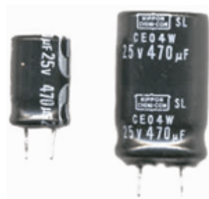
FIG. 14 – Comparaison entre un ancien et un condensateur chimique récent, aux caractéristiques identiques (25 V, 470 \mu\text{F} )
