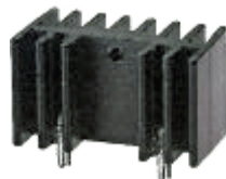
FIG. 66 – Dissipateur pour boîtier TO220, de résistance thermique 18^{\circ}\text{C}/\text{W}
