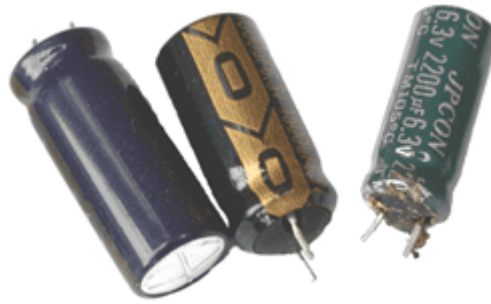
FIG. 15 – Condensateurs électrolytiques aluminium ayant gonflés (le 1 er par dessus, le 2 e par dessous et du liquide électrolytique s'est échappé du 3 e )
